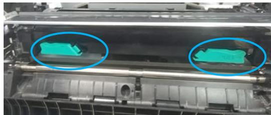
**8** Поверните защелку направляющей бумаги против часовой стрелки, чтобы вернуть ее в исходное положение.
