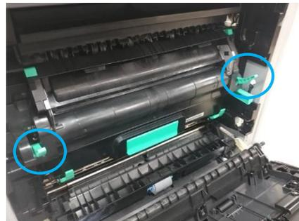
**2** Сдвиньте на себя фиксаторы крышки блока термозакрепления и откройте крышку. Аккуратно извлеките замятую бумагу.
