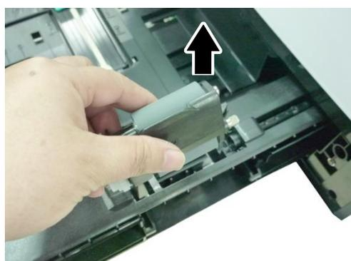
**3** Возьмите новый модуль с подающим роликом и роликом захвата бумаги, вставьте его на место извлеченного модуля и закройте, опустив крышку роликов вниз.
