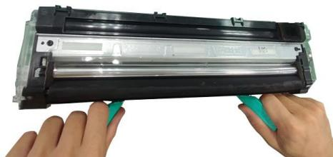
**8** Держась за рукоятки обеими руками, установите передний край блока проявки поверх рельсовых направляющих устройства.
