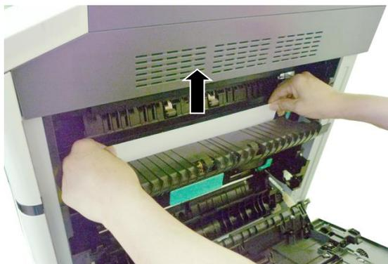
2. После извлечения замятого листа проверьте, вся ли бумага извлечена. Если лист разорван, проверьте, не остались ли внутри устройства обрывки, которые нужно извлечь. Оставшиеся внутри обрывки мешают прохождению бумаги и снижают качество изображения.
