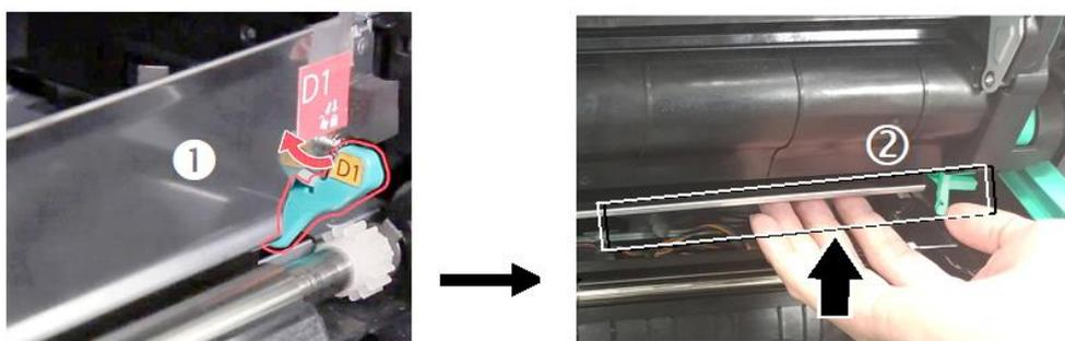
**3** Достаньте блок проявки из упаковочного пакета, а затем удалите с блока проявки ленту **1** и защитную пленку **2**.
