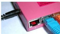
**2** Подключите другой конец сетевого кабеля к порту [LAN] на задней панели устройства.
