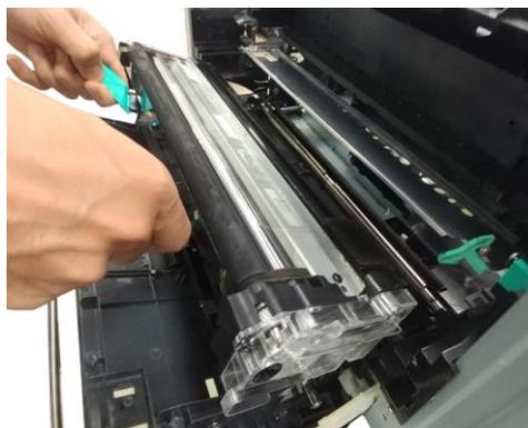
**7** Аккуратно задвиньте блок проявки полностью в устройство до его фиксации (защелкивания). Сложите ручки и выровняйте их с поверхностью блока проявки.
