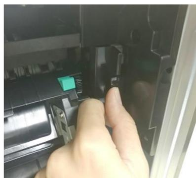
**16** Закройте крышку блока термозакрепления и поднимите рукоятки с обеих сторон.
