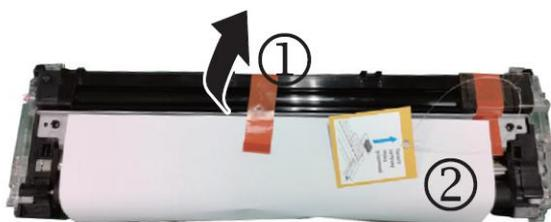
**4** Удалите с правого верхнего угла блока проявки ленту **3**, а затем удалите поролоновую прокладку **4**.
