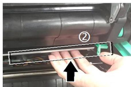
**4** Откройте рукоятки блока проявки, возьмитесь за них обеими руками и вытащите блок проявки из устройства.
