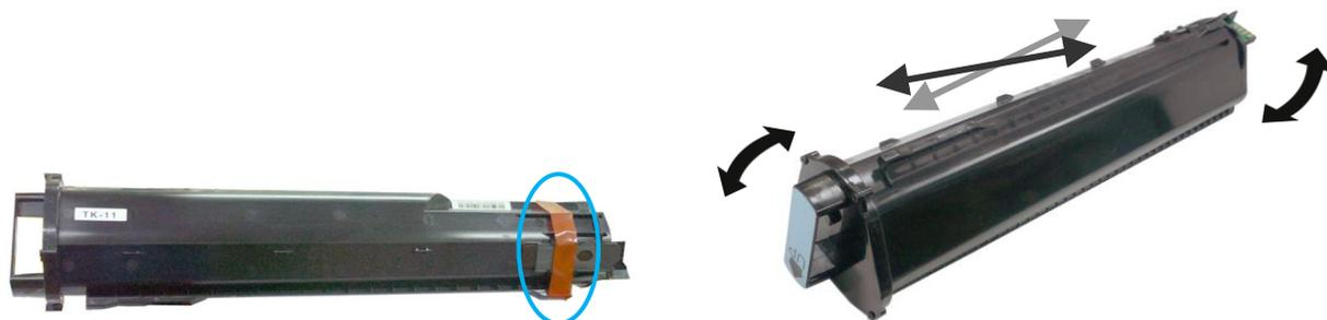
**3** Удерживая ручку тонер-картриджа, установите его в ячейку, как показано ниже, и задвиньте до упора в устройство.
