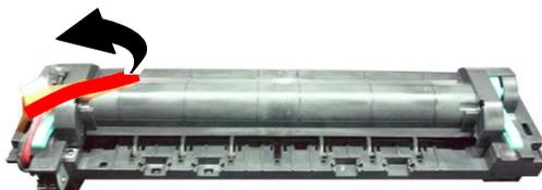
**11** Переверните блок термозакрепления и найдите серийный номер (десять цифр). Запишите его, так как он потребуется для сброса счетчика.
