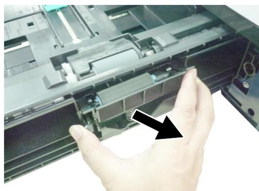
**5** Возьмите новый модуль реверсивного ролика и установите его на место снятого модуля.
