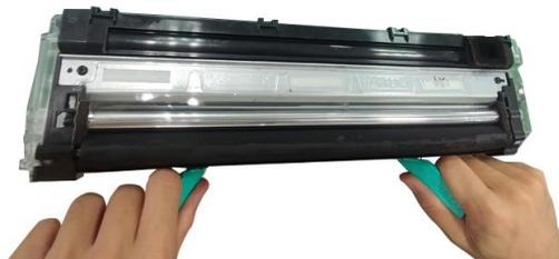
**6** Держась за рукоятки обеими руками, установите передний край блока проявки поверх рельсовых направляющих устройства.
