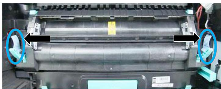
**14** Сдвиньте на себя фиксаторы крышки блока термозакрепления и откройте крышку.
