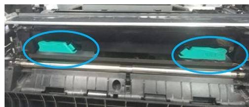
**10** Поверните защелку направляющей бумаги против часовой стрелки, чтобы вернуть ее в исходное положение.
