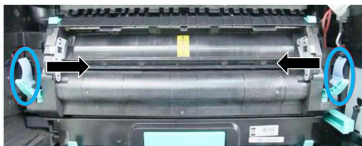
**8** Возьмитесь за рукоятки блока термозакрепления с двух сторон и извлеките его из устройства.
