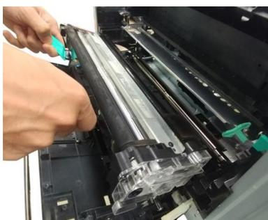
**9** Аккуратно задвиньте блок проявки в устройство по направляющим. Сложите рукоятки и выровняйте их с поверхностью блока проявки.
