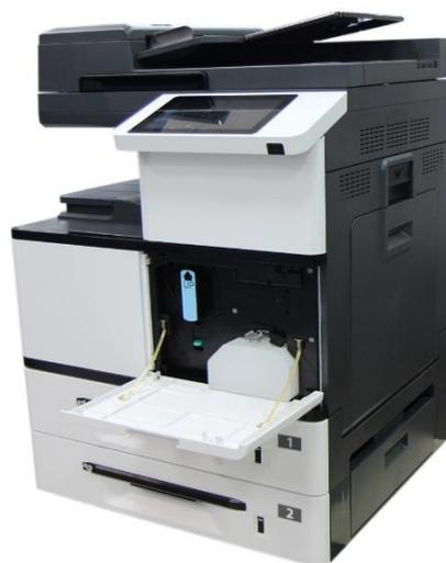
**2** Разблокируйте тонер-картридж, нажав правой рукой на выключатель блокировки, и при этом левой рукой потяните за ручку тонер-картриджа и вытащите его из устройства.
