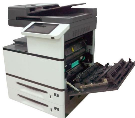
**3** Сдвиньте на себя фиксаторы крышки блока термозакрепления и откройте крышку.
