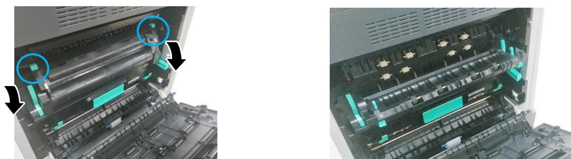
**5** Нажмите на защелку крышки разъемов и снимите ее.
